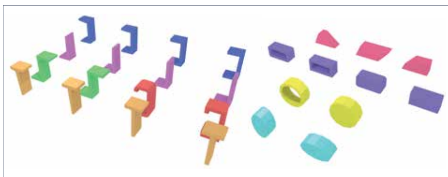
Figuur 1 - IFC kent veel parametrisch gecurve vormen zoals gebaseerd op de letters U, L, Z, C en T (links) en op trapezijs, (afgeronde) rechthoeken, cirkels met en zonder gaten en ellipsen (rechts).
