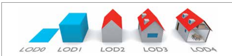
Figuur 1 - De detailniveaus voor gebouwen in CityGML. (Biljecki et al, 2017)
