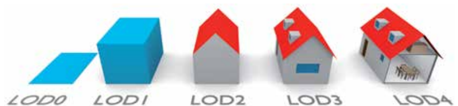
Figuur 2 - De detailniveaus voor gebouwen in CityGML.
